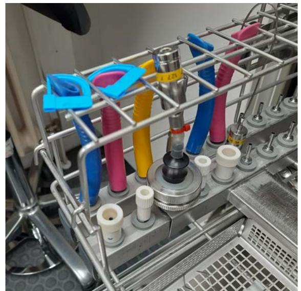
Abb. 6: Test 1: Detailansicht Überprüfung des Spüldrucks
