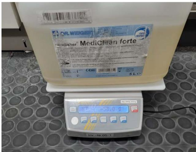
Abb. 9: Überprüfung der Dosierung (Reiniger)
