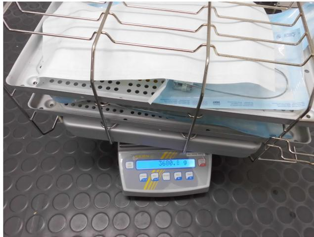
*Abb. 8: Überprüfung der Trocknung*
