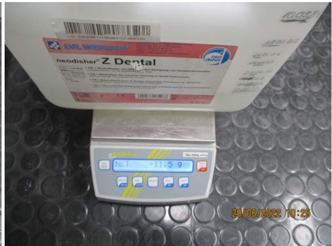
Abb. 15: Überprüfung der Dosierung (Neutralisator)
