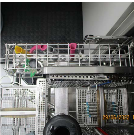
Abb. 10: Test 2: Detailansicht Überprüfung des Spüldrucks
