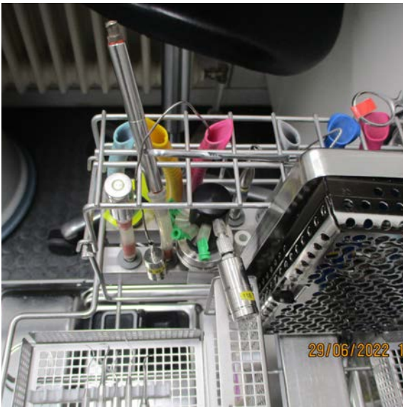
Abb. 6: Test 1: Detailansicht Lumcheck-Prüfkörper und Überprüfung des Spüldrucks
